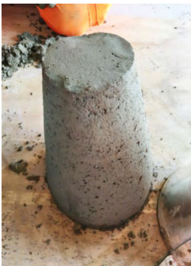
Wi Mortar slump test
